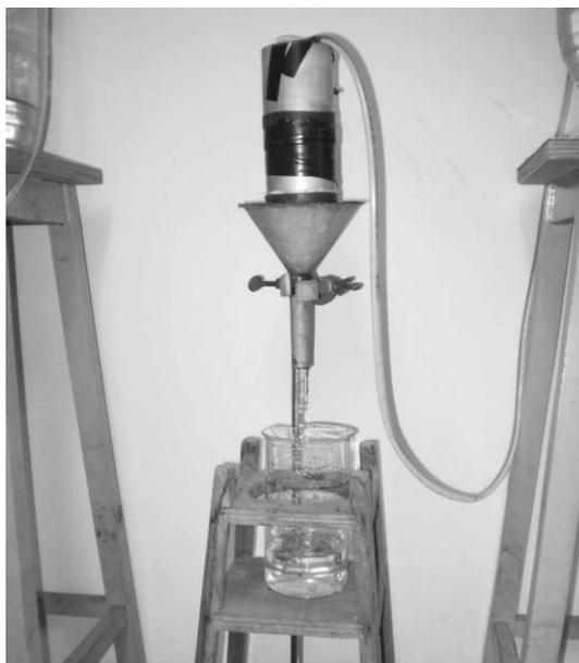
FIGURA 11B. Detalhe do cilindro mistura de areia e zeólita utilizado no ensaio de deslocamento miscível do ferro bivalente.
