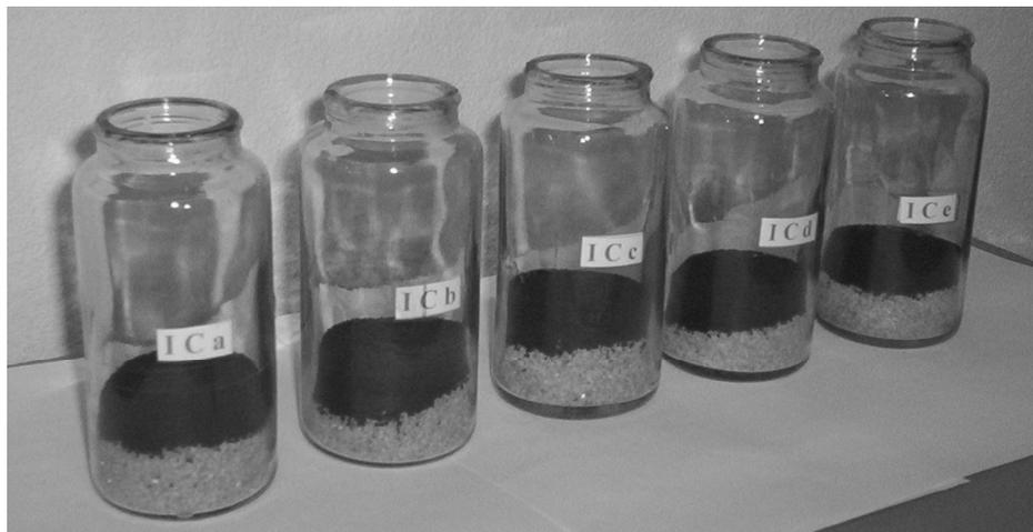
FIGURA 4B. Vidros contendo 50 % de areia e 50 % de zeólita (em volume).
