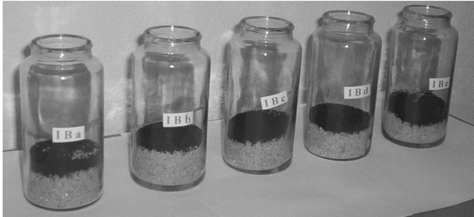
FIGURA 3B. Vidros contendo 75 % de areia e 25 % de zeólita (em volume).
