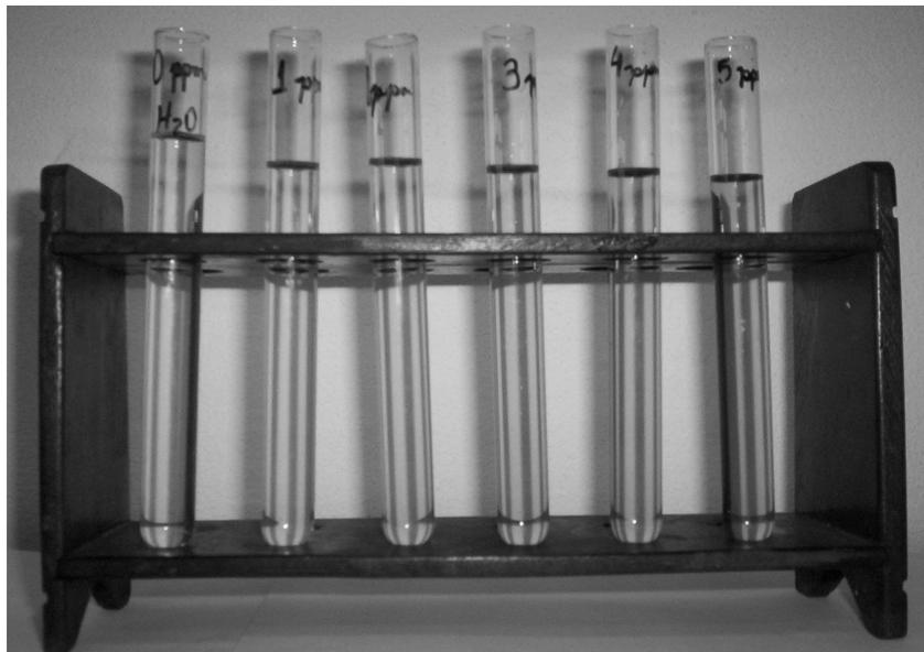
FIGURA 6B. Soluções com teores de ferro conhecidos (0 a 5 ppm) utilizadas para a calibração do espectrofotômetro colorimétrico.
