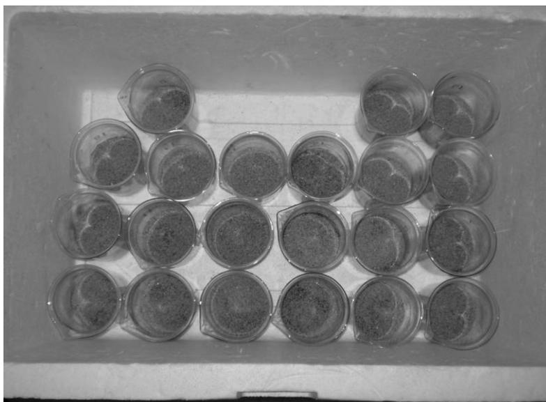
FIGURA 8B. Mistura de areia e zeólita utilizada para determinação da isoterma de adsorção.
