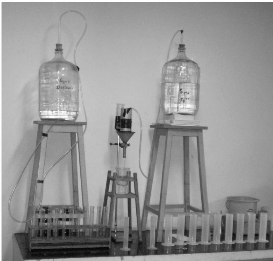
FIGURA 9B. Ensaio de deslocamento miscível de ferro bivalente em mistura de areia e zeólita.
