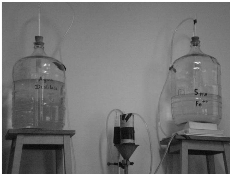
FIGURA 10B. Vidros de Mariotte contendo água destilada e solução de ferro bivalente na concentração de 5ppm.
